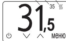
Нажмите и удерживайте левую кнопку в течение 5 с. После отключения терморегулятор перейдет в спящий режим. Для полного отключения выньте терморегулятор из розетки или отключите автоматический выключатель в щитке при длительном перерыве в использовании.
