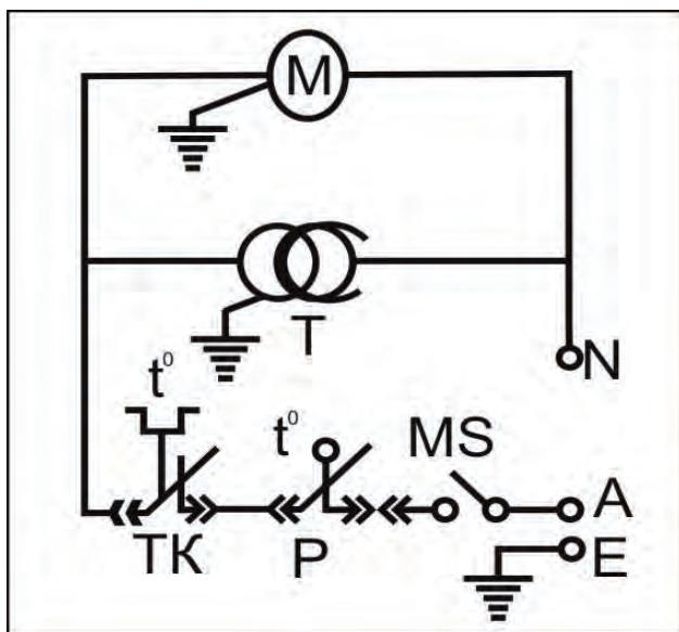
Приложение А. Схема соединений компрессора, мотора и вентилятора
