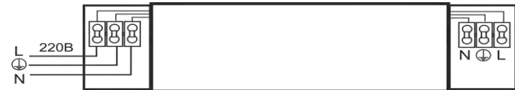
Рис. 4. Подключение СТЕП ПН к сети 220В
