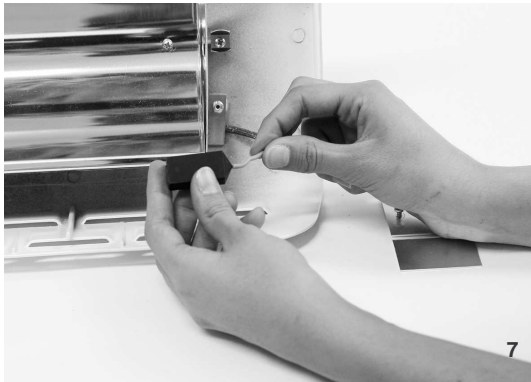
7. ОЧИСТИТЕ ПРОВОДА НА ДЛИНУ 5/6 ММ
