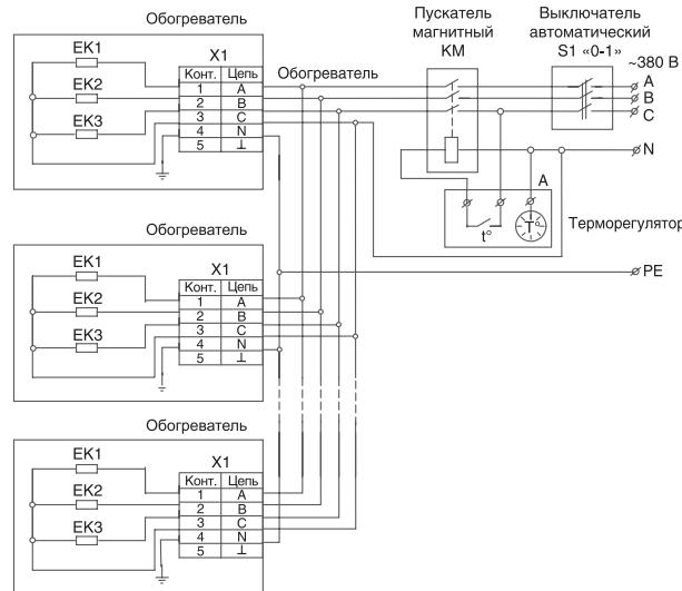
Рис. 4. Обогреватель BIH-T-3.0; BIH-T-4.5, BIH-T-6.0
