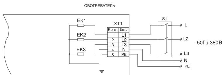
Рис. 2. Обогреватель BIH-T-3.0; BIH-T-4.5, BIH-T-6.0
