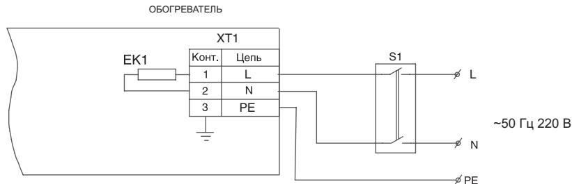
Рис. 1. Обогреватель BIH-T-1.0; BIH-T-1.5; BIH-T-2.0
