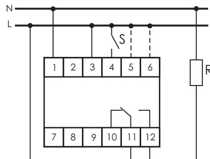
При замыкании контакта S начинается отсчет установленной выдержки времени по истечении которой включается исполнительное реле (замыкаются контакты 11-12). В таком положении реле находится до отключения питания или размыкания контакта S. Если разомкнуть контакт S до истечения выдержки времени, отсчёт прекращается. При замыкании контакта S отсчёт начинается снова.
