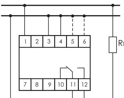
После включения питания и отсчета установленной выдержки времени исполнительное реле включается, замыкаются контакты 11-12. В таком положении реле находится до отключения питания.
