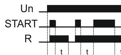
H - подача напряжения на вход START вызывает включение исполнительного реле, а сброс его начало отсчета времени t. Подача последующих импульсов START и сброс его вызывает продолжение цикла работы на время t.
