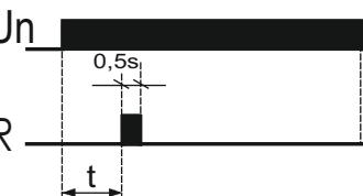
E- замыкание контактов исполнительного реле на время 0,5 секунды . По истечении заданного времени t.
