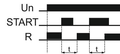
K - Выключение реле на определенное время t. При подаче напряжения на вход START начинается отсчет времени. В ходе отсчета устройство не реагирует на сигнал START.
