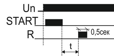
I - По окончании подачи напряжения на вход START начинается отсчет заданного времени t по истечении, которого, контакты исполнительного реле замыкаются на время -0,5 сек.
