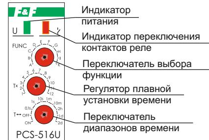
Реле времени программируемое PCS-516U выполнено в одномодульном корпусе для крепления на DIN-рейку 35мм. На панели управления находятся индикаторы питания, переключения контактов исполнительного реле, регулятор плавной установки времени, переключатель диапазонов времени, переключатель выбора функции.
