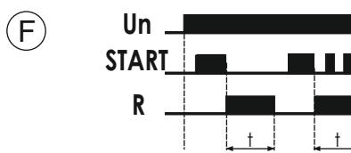
**Реле включается на время t при снятии импульса START.**
