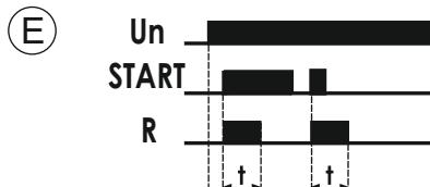
**Реле включается на время t при подаче импульса START.**
