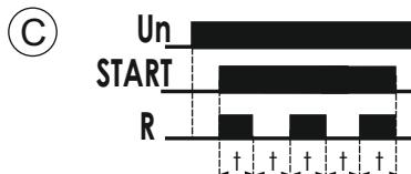
**Генератор с коэффициентом заполнения 50%, начинающий работу с подачи напряжения питания.** Реле работает во время подачи напряжения START. При его снятии работа прекращается.
