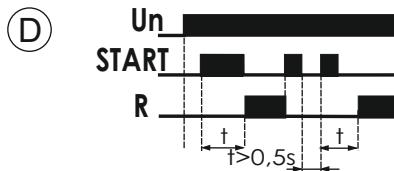
**Включение реле сигналом START с задержкой.** В момент, когда реле включено, очередной импульс START отключает его. Следующий импульс START вызывает повторный отсчет времени и вызывает повторный отсчет времени и включение реле. Перерыв между импульсами - не менее 0,5 сек.
