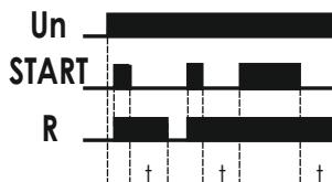
**Задержка выключения с возможностью продления.** Фронт импульса START вызывает включение реле, а спад его начала отсчета времени. Спад импульса START в ходе отсчета времени вызывает продолжение цикла на очередное время t.
