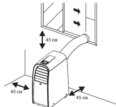
1. Выберите подходящее место для установки кондиционера с удобным доступом к электрической розетке.
